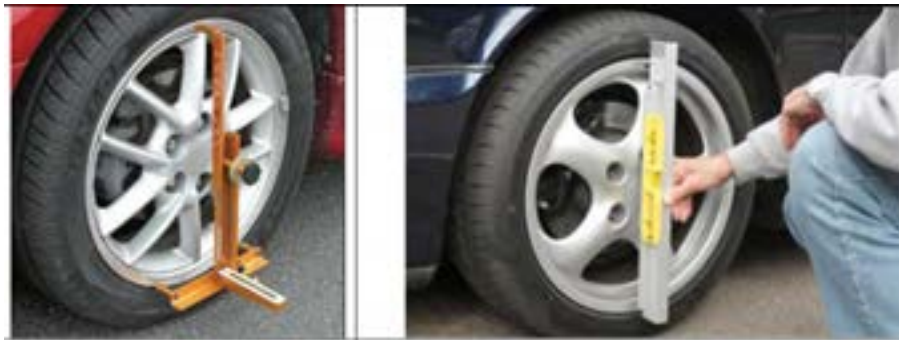
شکل ۴۳- ابزار مخصوص بررسی و تنظیم زوایای چرخ
