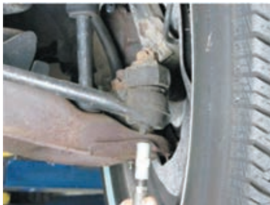
شکل ۳۳ - روش گریس کاری سیبک
