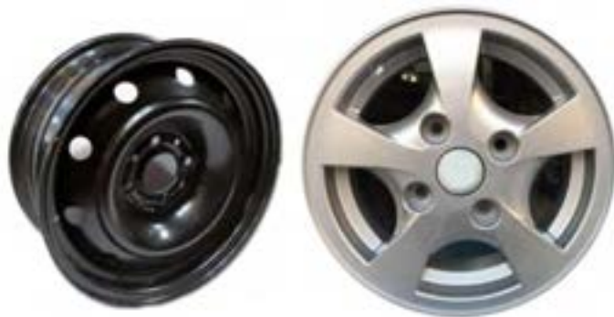
شکل ۹- رینگ آلومینیومی و فولادی
