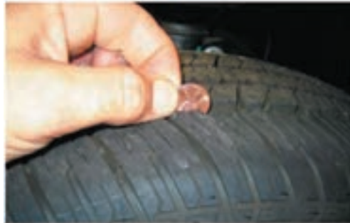
شکل ۱۶- نحوه اندازه‌گیری تقریبی شیار تایر
