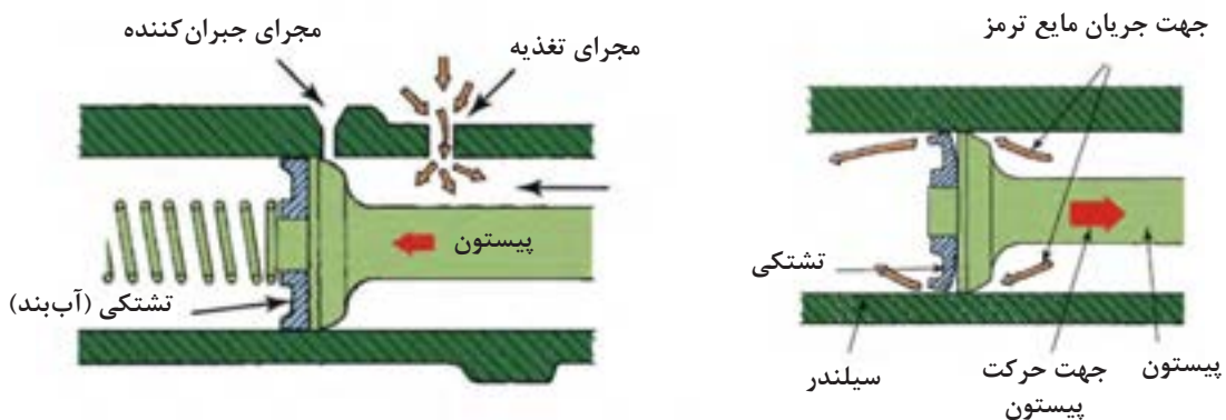
شکل ۱۲- عملکرد تشتکی پیستون
