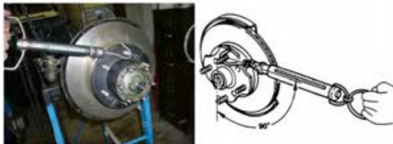
شکل ۱۸- بررسی توپی و بلبرینگ یا رولبرینگ
