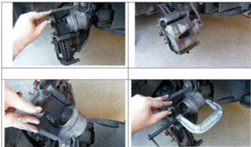
شکل ۳۳- مراحل باز کردن کالیپر ترمز
