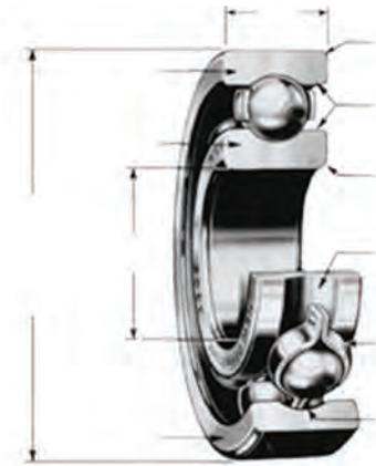
شکل ۵- ساختمان و اجزای بلبرینگ
