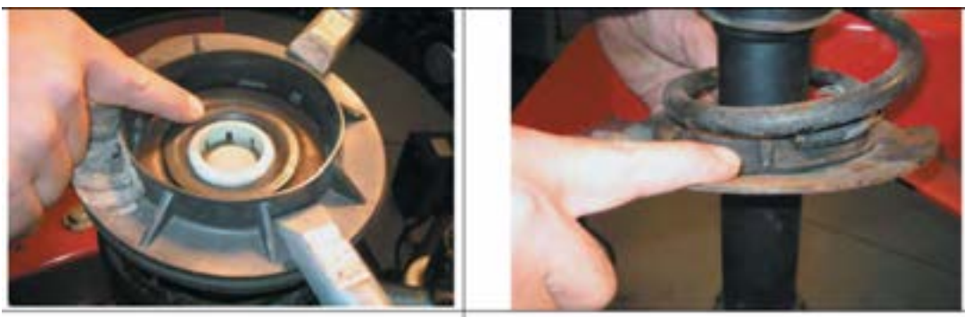
شکل ۳۷- برخی نکات مهم در هنگام بستن مجموعه مک فرسون
