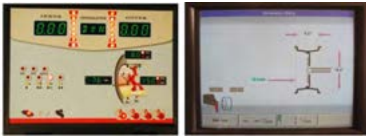
شکل ۳۱- صفحه نمایش دو نوع دستگاه بالانس دینامیکی
