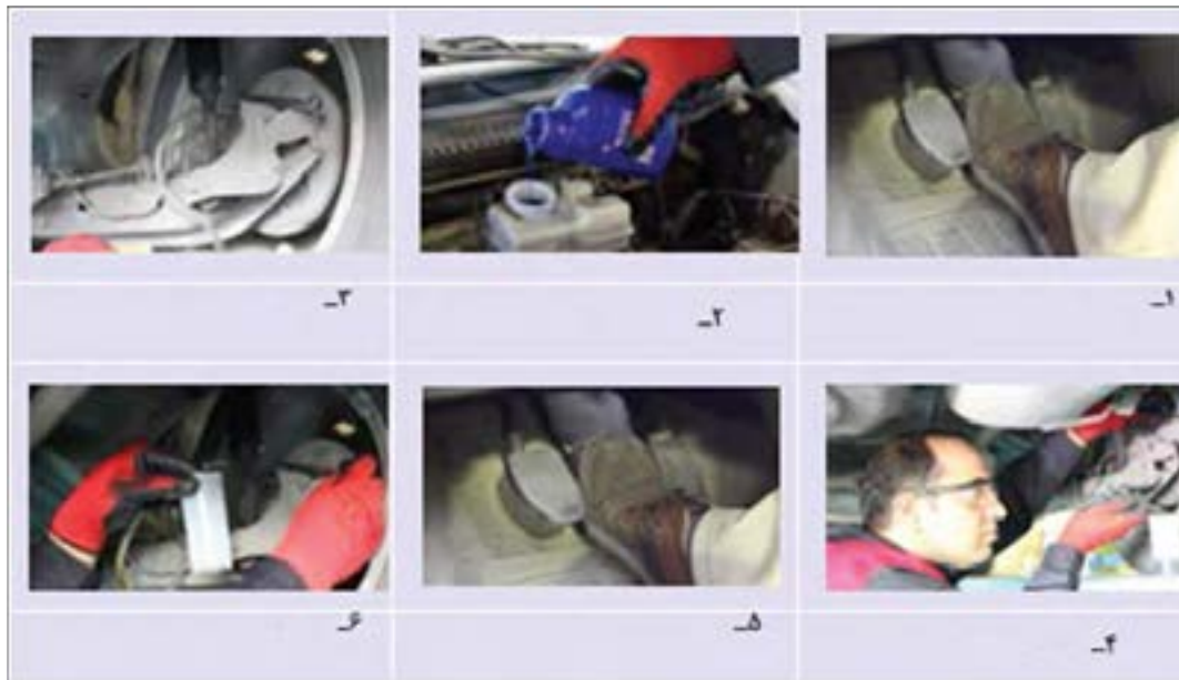
شکل ۱۹- مراحل هواگیری دستی مدار هیدرولیک ترمز
