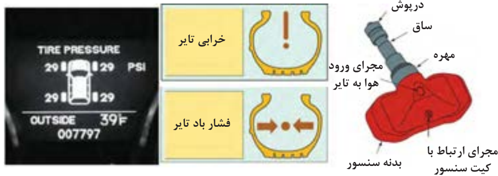
شکل ۱۳- حسگر فشار باد تایر و چراغ هشدار مربوطه در صفحه نشان‌دهنده‌ها
