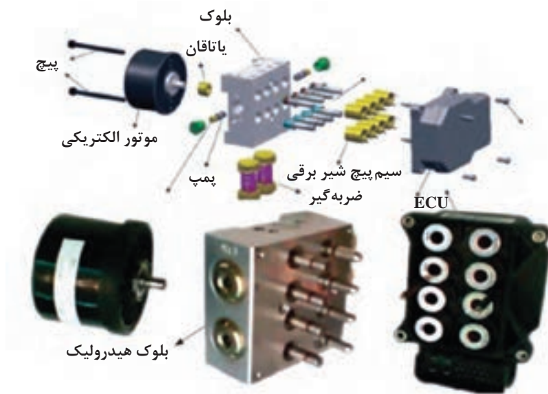
شکل ۴۸- بلوک هیدرولیک سیستم ترمز ضد قفل
