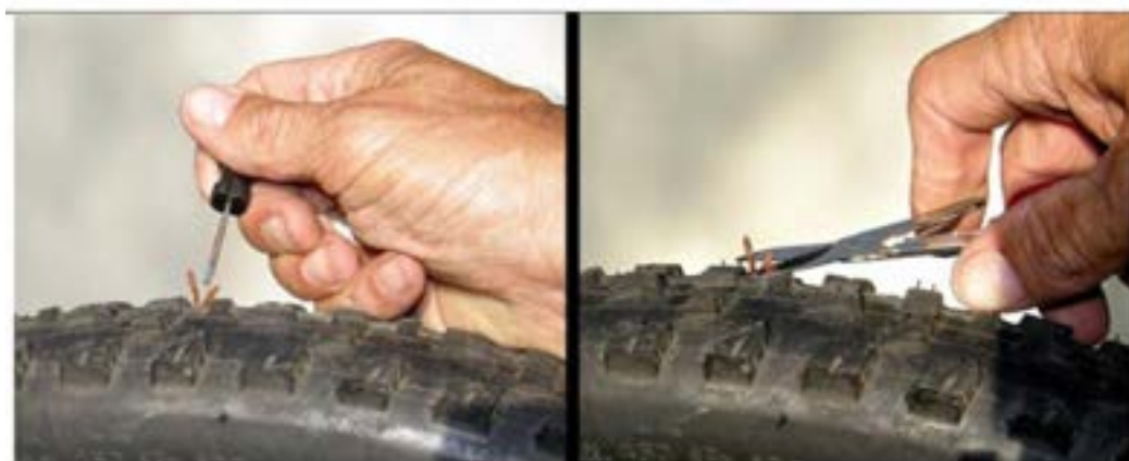
شکل ۲۶- مراحل پنچرگیری تایر بدون تیوب
