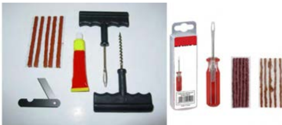
شکل ۲۵- ابزار مخصوص پنچرگیری تایر بدون تیوب (تیوبلس)
