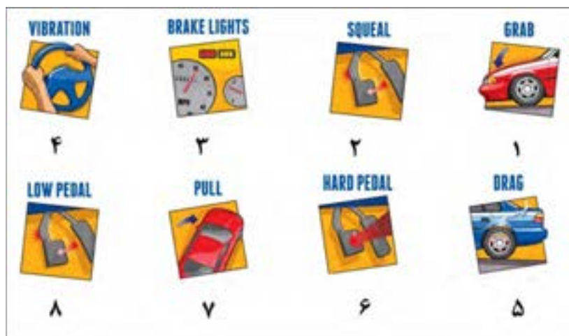
شکل ۲۱- آثار مهم خرابی سیستم ترمز
