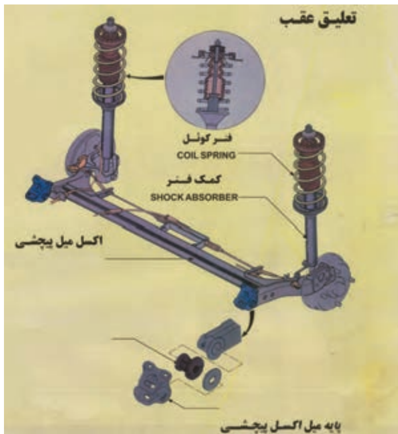
شکل ۴۹- تعلیق با اکسل میل پیچشی
