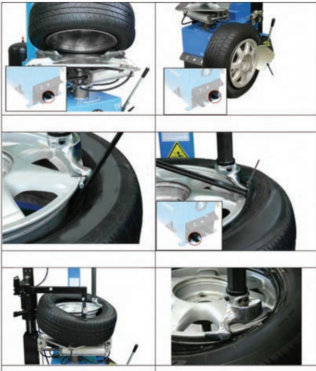
شکل ۳۳- مراحل استفاده از دستگاه لاستیک در آر پنوماتیکی
