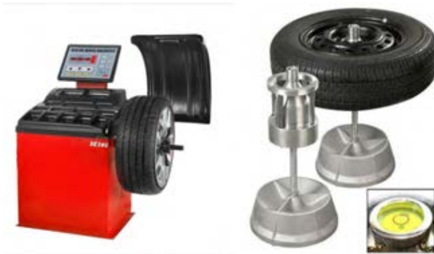
شکل ۳۰- دو نوع دستگاه بالانس چرخ (استاتیکی و دینامیکی)
