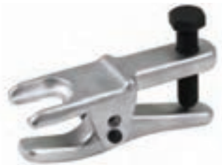
شکل ۲۸- نمونه‌ای از گیره مخصوص (سیبک کش)
