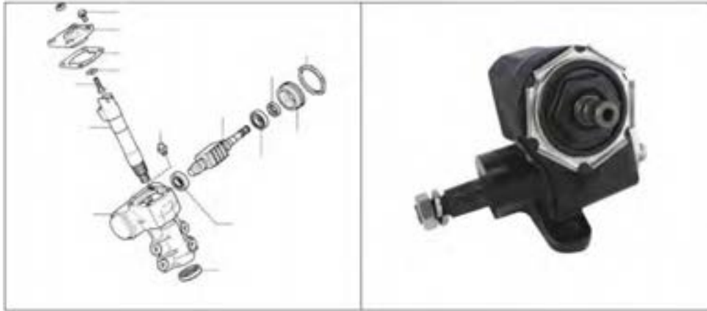
شکل ۲۹ - نوعی مکانیزم تنظیم لقی طولی ماریپیچ فرمان
