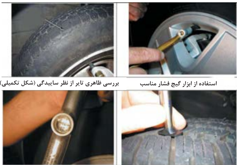
شکل ۱۵- مراحل بررسی تایر
