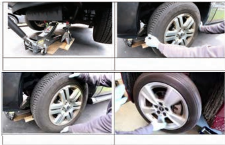
شکل ۱۷- مراحل بررسی بلبرینگ یا رولبرینگ چرخ در حالت توقف خودرو
