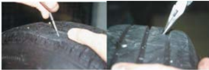
شکل ۲۱- روش بررسی و خارج کردن جسم خارجی از تایر
