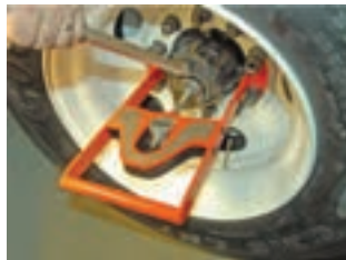
شکل ۲۱- روش تنظیم پیش‌بار بلبرینگ یا رولبرینگ
