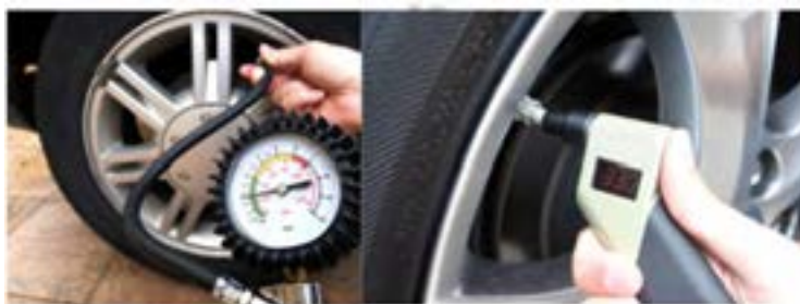
شکل ۲۰ - شیوه بررسی و تنظیم فشار باد تایر
