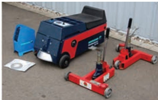
شکل ۲۳- نوعی دستگاه بالانس درجای چرخ
