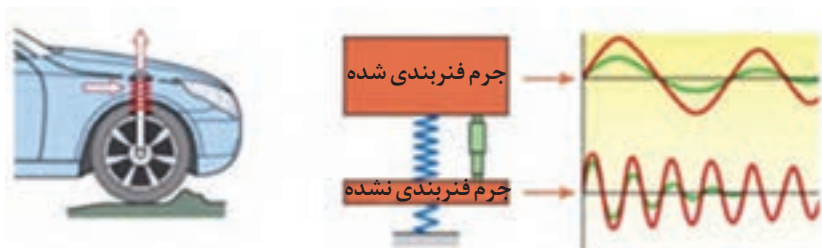
شکل ۲۷- عملکرد سیستم فنربندی تعلیق
