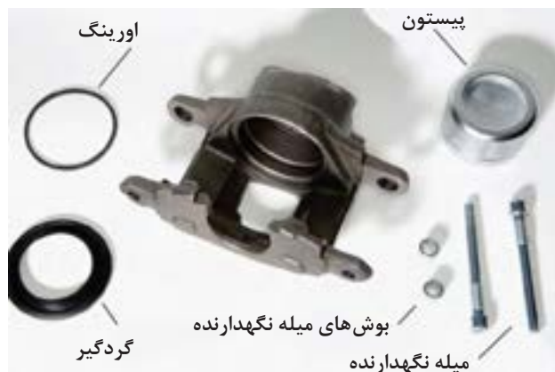
شکل ۳۶- اجزای مجموعه هیدرولیکی کالیپر ترمز
