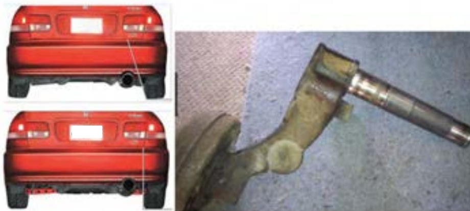
شکل ۴۶- خرابی بوش‌ها و تأثیر آن روی چرخ
