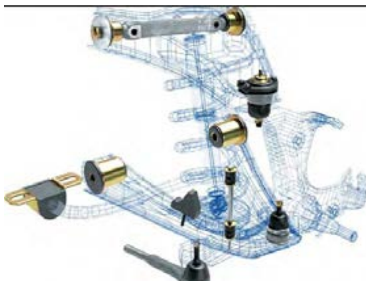
شکل ۱۲- انواع اتصالات لاستیکی
