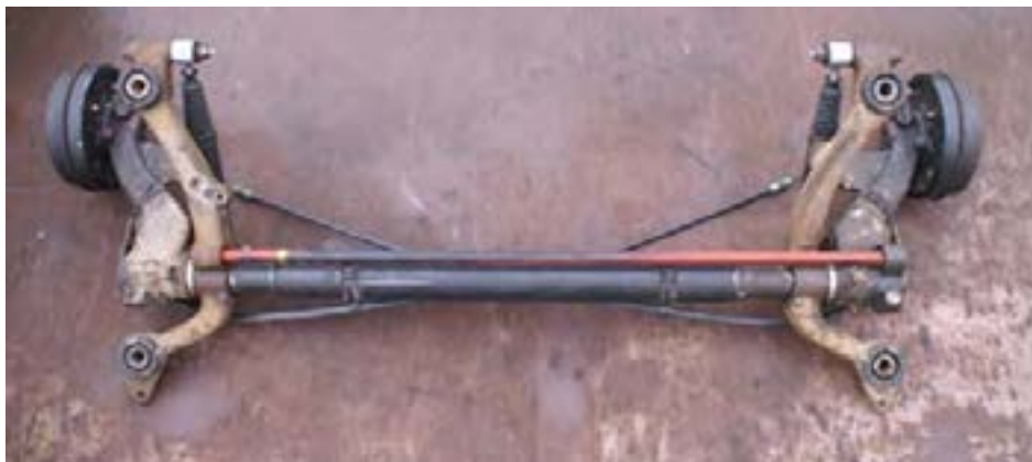
شکل ۴۴- مجموعه تعلیق عقب میله کشنده
