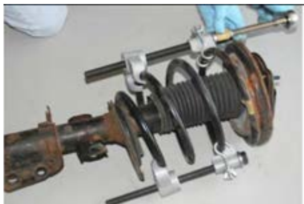
شکل ۳۶- برخی نکات باز کردن سیستم مک فرسون
